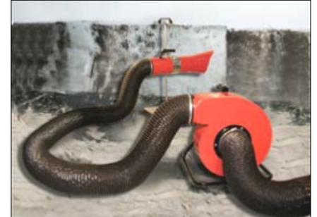
Tragbarer Ventilator eingesetzt zur Trocknung einer feuchten Wand.
